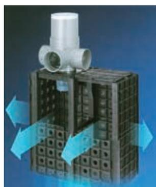
「レインキューブ」は、再生PP製の下部ユニット(キューブ)、塩ビ製の上部マスと立上がり管、フタで1セット。下部ユニットは、高さ60cmと30cmの2タイプがあり、設置する時は透水シートを巻いて埋設する。地表に出るのは掃除口となるフタの部分だけなので、景観を損なうことなく、狭小地にも設置可能。再生PPを使用したエコ製品であることも、高評価のポイント。
