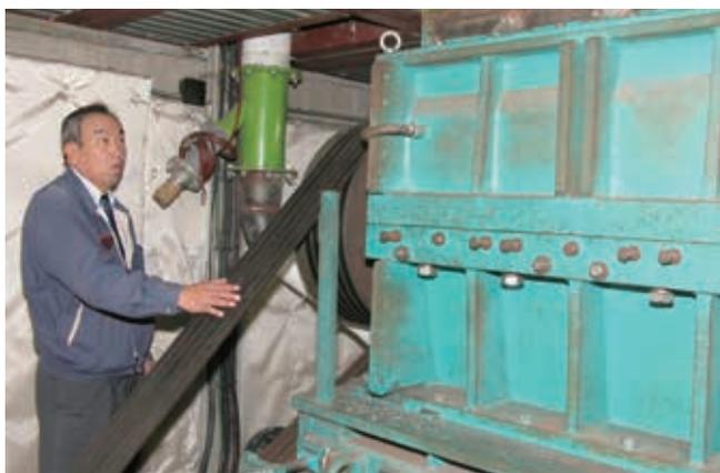
破碎機について説明する浅野常務。騒音対策のため地下に設置して、四壁を防音シートで覆っている。発熱量が大きいので、クーラーで冷却する。
