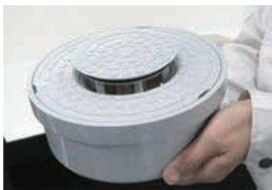
こちらは、雨水の逆流でも外れたり紛失したりしないマス用の「圧力開放蓋」。逆流時、下水道本管から内部空気圧・水圧が加わると、内側の小蓋が浮き上がり、圧力を逃がすことで、蓋の離脱を防ぐ。
