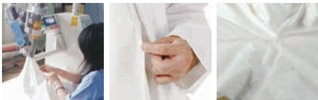
塩ビならではの超音波ミシンによる無縫製加工 水滴や血液の浸入を防止する切り返し加工 股部分は、つなぎ目に補強テープを圧着し強化
