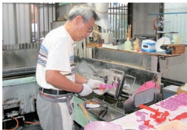
経験がモノを言う、金型からの抜き出し工程（フジトイの試作品づくりを請け負う葛飾区の(有)エース企業。画面左奥に見えるのがオイル槽）。
