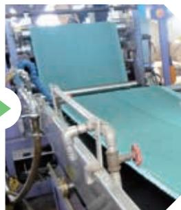
カツロン栃木工場の押出成形機で、リサイクルシートに加工される。(幅60cm×長さ5m)
