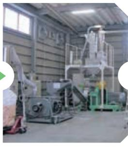
照和樹脂のつくば工場で、5～10mmに破碎した後、高速・高剪断混合溶融機に投入する。
