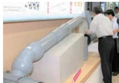
可動性を触って確認。耐震配管モデル
