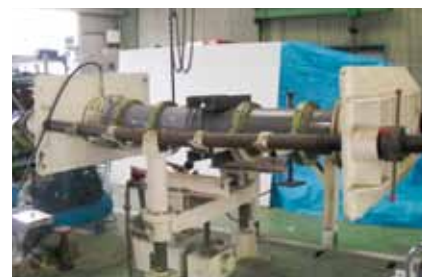
接合部の気密試験の様子
