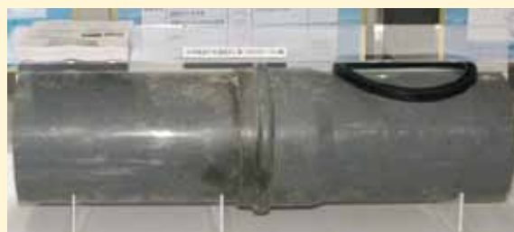
埋設後30年経過した塩ビ管（「下水道展 '11東京」）
