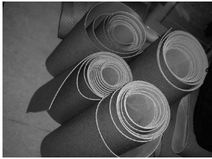
施工後の塩ビシート余材
