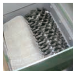
繊維層を完全分離した塩ビパッキング層。二軸破碎機で親指大に破碎
