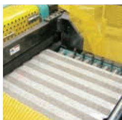
3段階に分け、トラ刈状に繊維層を削り取っていく (白い所が切削部分)
