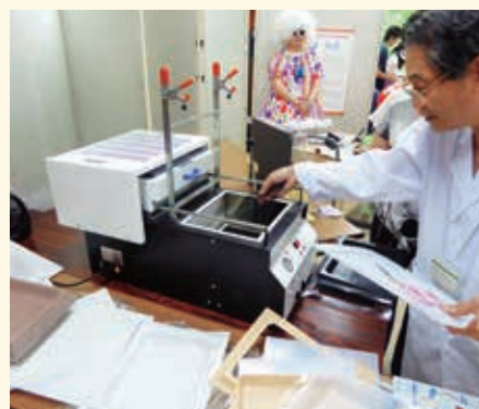
発泡スチロールトレイの実演成形
