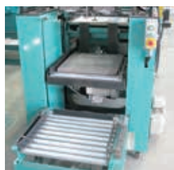
新たに開発した自動供給機。一回で約70枚まで連続投入が可能
