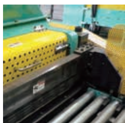
刃が装着されたローターで切削。
