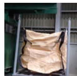
フレーク加工された塩ビのパッキング層は、フレコン詰めになされて出荷される
