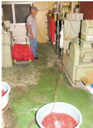
ロープを水で冷ましながらか、巻き取り機に掛け、一定の長さに切断
