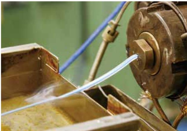
原料の塩ビを約150℃で溶かし、押出機でロープ状にしていく(写真は二重複合成型ライン)。
