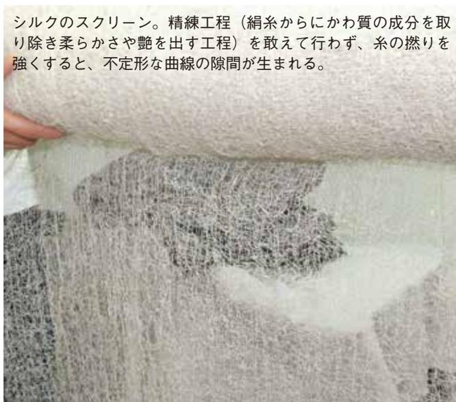
シルクのスクリーン。精練工程（絹糸からにかわ質の成分を取り除き柔らかさや艶を出す工程）を取って行わず、糸の撚りを強くすると、不定形の曲線の隙間が生まれる。
