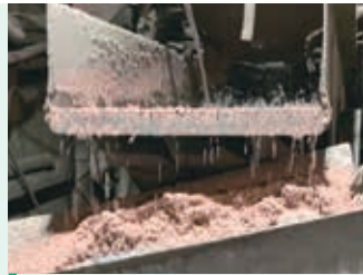
STEP 5 振動篩機と水流で銅と樹脂を分離
