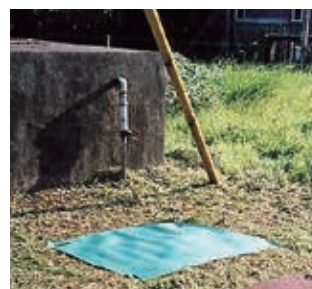
リサイクル防草シート試作品の屋外暴露試験の様相
