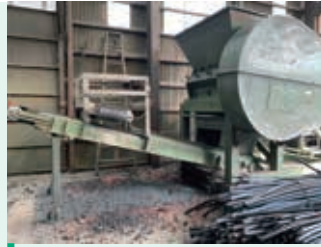
STEP 2 破砕処理機で適度な寸法に破砕
