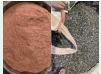
STEP 7 磁選、乾燥を経て製品化完了（左が銅、右が塩ビ）
