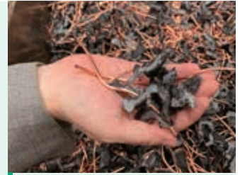
STEP 3 破砕処理後の銅と被覆
