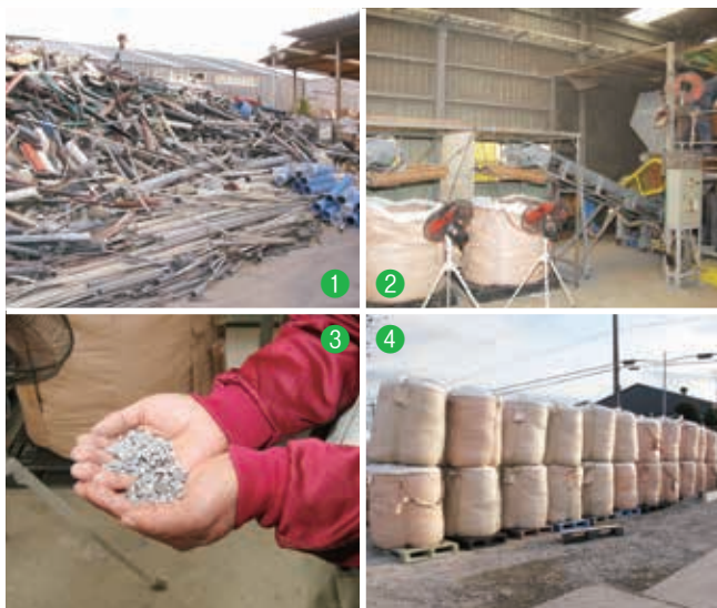
①ストックヤードに山積みされた使用済み塩ビ管 ②廃プラスチック破砕機 ③塩ビ管の再生原料。サイズは15mm程度 ④フレコンパックされて出荷を待つ再生原料
