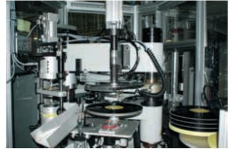
カッティングは東京のソニー・ミュージックスタジオでの作業)。最後のプレス工程では、スタンパーを取り付けた金型を高音蒸気で暖め、樹脂をプレスして溝を転写し、プレス途中のあるタイミングで金型に冷却水を通して盤を冷やすといった細かな調整を行っています。
