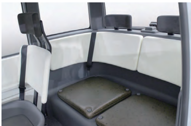
リサイクルを前提とし、座面を取り外しやすくしている。留め具部分も塩ビ製で、モノマテリアル化。
