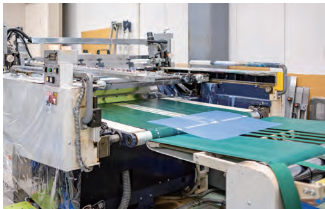
1時間に平均800枚印刷が可能なシルクスクリーン用印刷機
