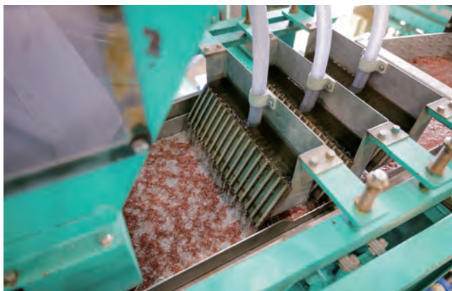
湿式ナゲットプラントで水流を使いながら、選別されていく銅
