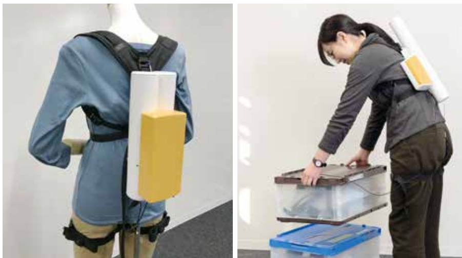
腰サポートウェア「heige（ハイジ）LS」の1号機（左）と作業イメージ
