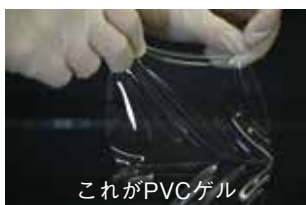
PVCゲルの人工筋肉 積層型アクチュエータの原理
