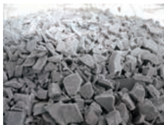
STEP 6 検収仕分け 20mmのスクリーンを通して粒度調整
