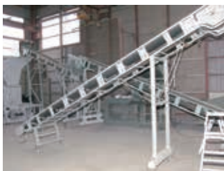
STEP 5 破碎～粉碎 粗破碎した後、さらに細かく粉碎
