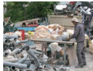
STEP 3 切断 破砕機に投入できるサイズに切断
