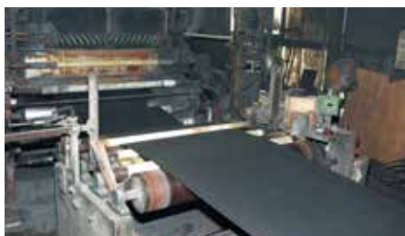
部出しロールで、用途に合わせ厚みを調整。
